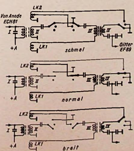
Rechts: Bild 2a...c. Das vierkreisige Steilfront-Regelfilter in den drei Schaltstellungen
