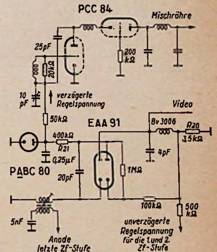
Rechts: Bild 68. Regelautomatik des Grundig-Fernsehempfängers Typ 550
