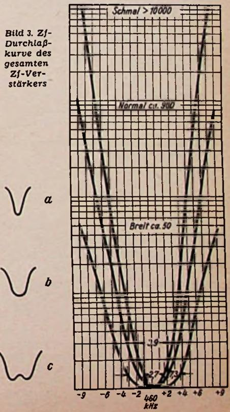
Bild 3. Zf-Durchlaßkurve des gesamten Zf-Verstärkers
