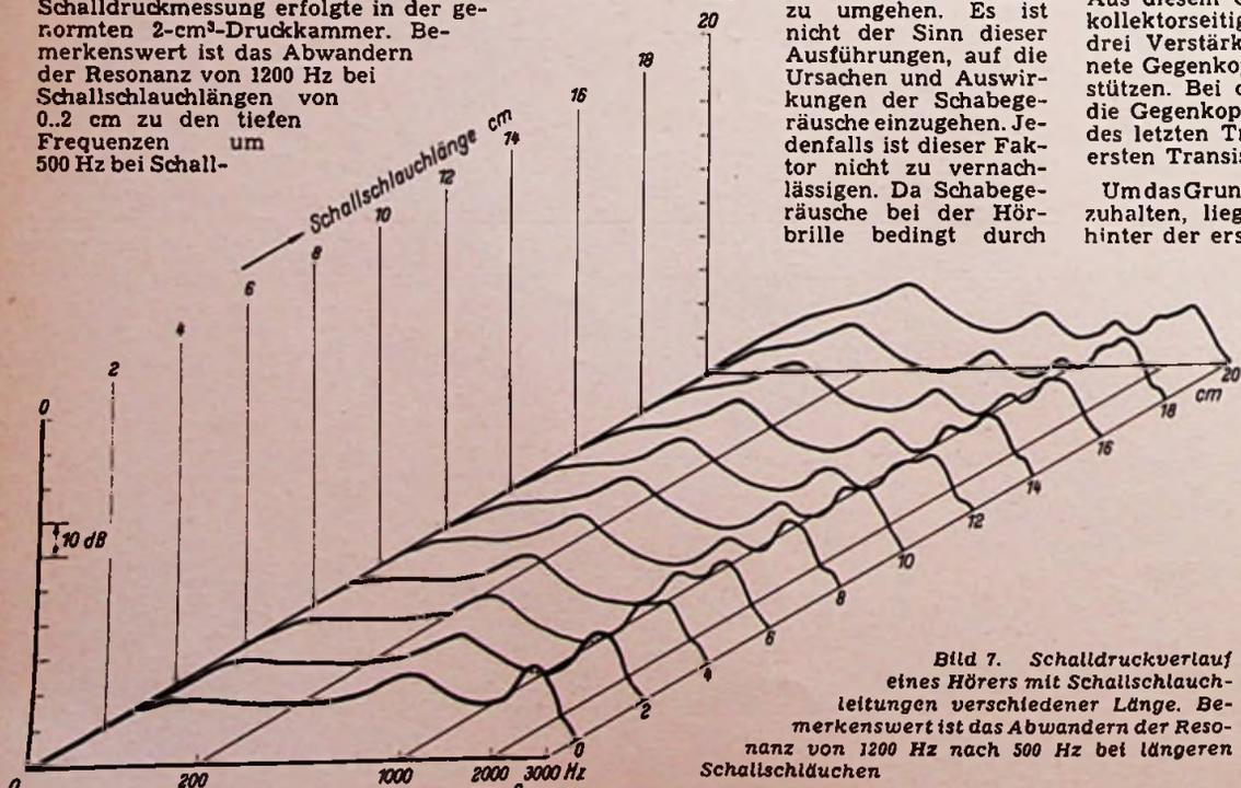
Bild 7. Schalldruckverlauf eines Hörers mit Schallschlauchleitungen verschiedener Länge. Bemerkenswert ist das Abwandern der Resonanz von 1200 Hz nach 500 Hz bei längeren Schallschläuchen
