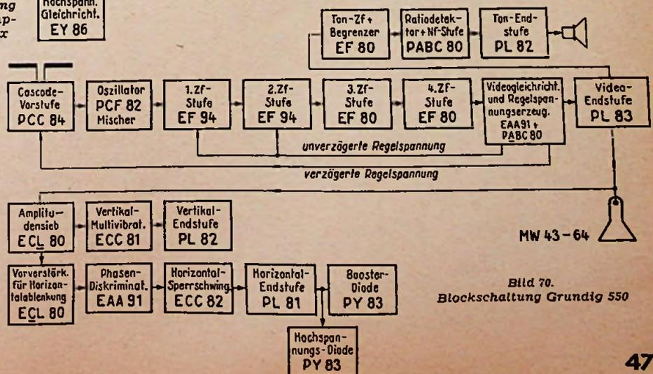
Bild 70. Blockschaltung Grundig 550
