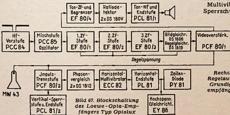
Bild 67. Blockschaltung des Loewe-Opta-Empfängers Typ Optalux
