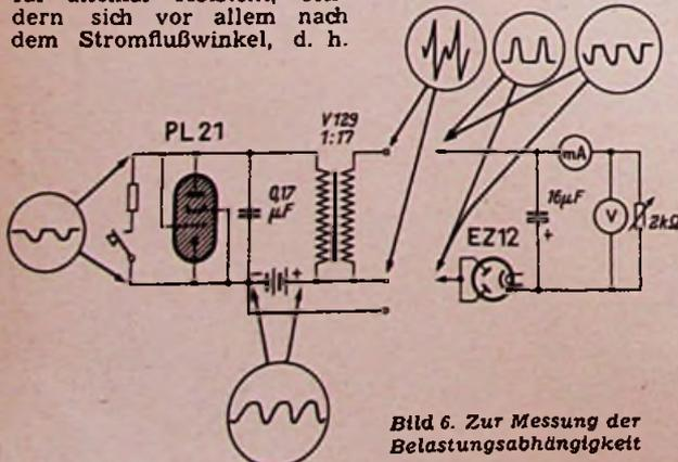
Bild 6. Zur Messung der Belastungsabhängigkeit
