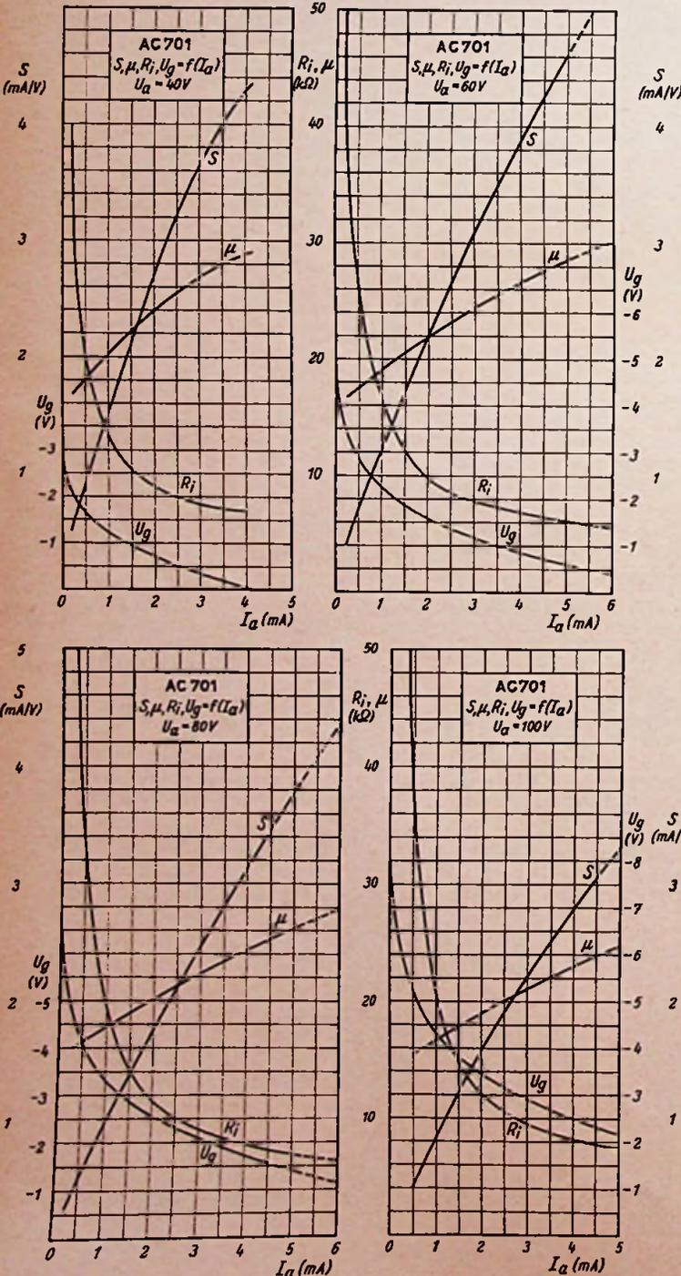
Bild 9. Steilheit, Verstärkungsfaktor, Innenwiderstand und Gittervorspannung über dem Anodenstrom für  $U_a = 40 \text{ V}$  und  $60 \text{ V}$
