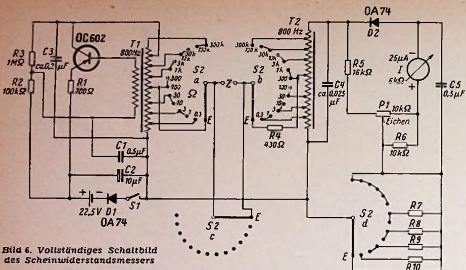
Bild 6. Vollständiges Schaltbild des Scheinwiderstandsmessers
