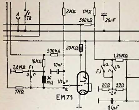
Bild 1. Teilbild der Rauschunterdrückungsschaltung beim Gerät Bodensee W III. Die durch schwarze Rechtecke gekennzeichneten 30-M $\Omega$ -Widerstände sind auf ihre Brauchbarkeit zu prüfen
