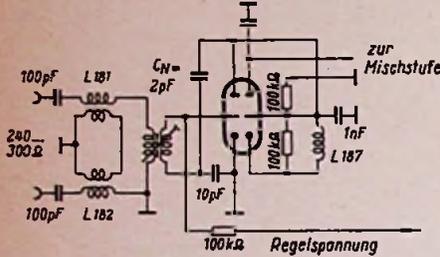
Bild 62. Eingangsschaltung des Metz-Fernsehempfängers 902/3 D mit Eingangssymmetrierung
