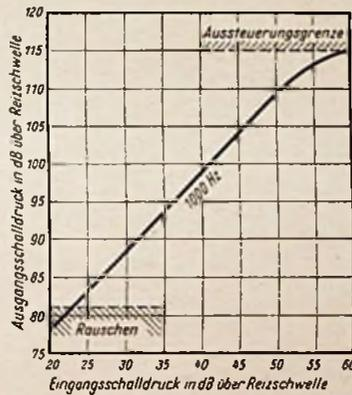
Bild 1. Ausgangsschalldruck als Funktion des Eingangsschalldrucks (ohne Gegenkopplung)
