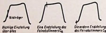
Bild 63. Wirkungsweise der Oszillator-Feinabstimmung bei Metz
