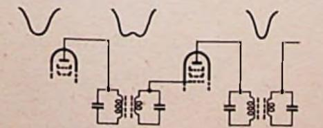
Bild 1. Anordnung der beiden zweikreisigen Bandfilter zwischen den beiden Röhren EF 89
