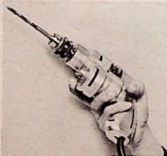
Das Gerät ist rufunkentstört, schutzgeerdet und mit dreidrigem Anschlußkabel und Schuko-stecker versehen. Die Bohrleistung beträgt 8 mm in Stahl. Im Leerlauf dreht sich die Bohrspindel mit 1450 U/min, bei Last mit 740 U/min. Gewicht mit Bohrfutter 1,7 kg. Vertrieb: Robert Bosch GmbH, Stuttgart.
