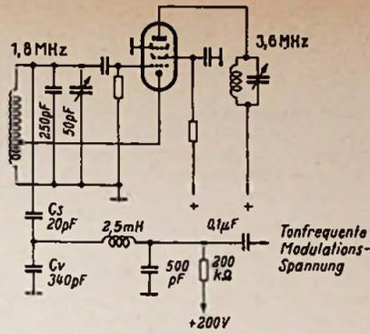
Bild 9. Eco-Schaltung mit Frequenzmodulation durch spannungsabhängigen Kondensator
