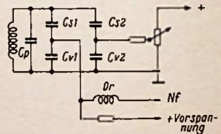
Bild 8. Schaltung zur Temperaturkompensation mit einstellbarem Temperaturkoeffizienten
