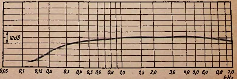
Bild 3. Elektrische Verstärkung als Funktion der Frequenz
