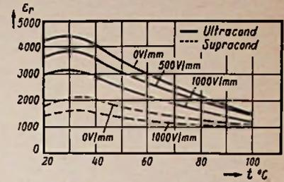
Bild 3. Feldstärkeabhängigkeit und Temperatureingang einiger Kondensator-Werkstoffe
