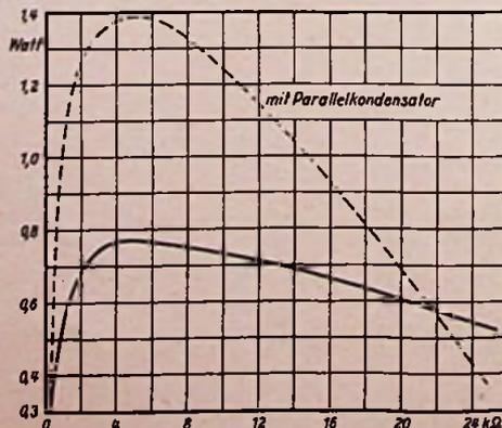
Bild 7. Abhängigkeit der auskoppelten Leistung von der Größe des Belastungswiderstandes. (Schaltung wie Bild 6, jedoch mit  $AU = 1:3$  und  $C = 0,47 \mu F$ ). Die gestrichelte Kurve zeigt die mögliche Verbesserung der Leistungsausbeute, wenn parallel zur Sekundärwicklung ein Kondensator zur Phasenkorrektur gelegt wird
