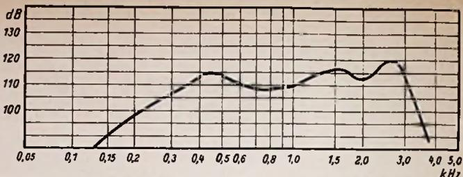
Bild 5. Schalldruck als Funktion der Frequenz. Schallschlauchlänge 6 cm, Eingangsschalldruck 65 dB über 2 · 10<sup>-4</sup> µb
