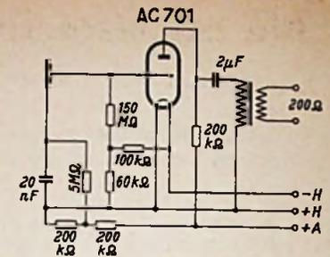
Bild 7. Mikrofonverstärkerschaltung für Mikrofonkapseln mit hochliegendem Gehäuse
