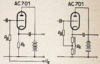
Bild 8. Verstärkerschaltung mit Katodenausgang
