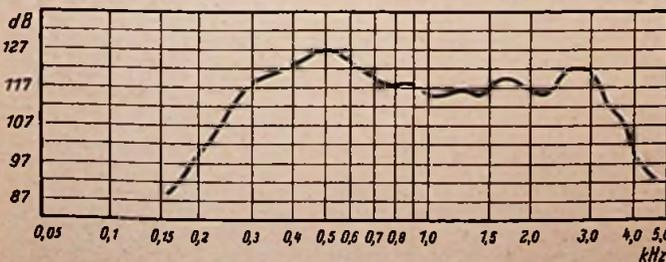
Bild 2. Maximaler Ausgangsschalldruck als Funktion der Frequenz
