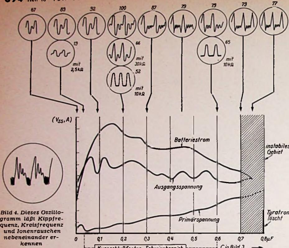
Bild 4. Dieses Oszillogramm läßt Kippfrequenz, Kreisfrequenz und Ionenrauschen nebeneinander erkennen
