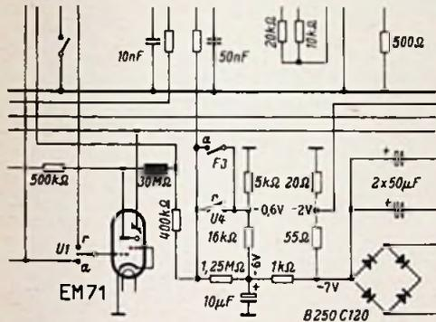
Bild 2. Teilbild der Rauschunterdrückungsschaltung des Freiburg W III
