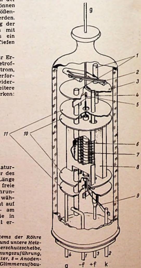
Bild 2. Schnittbild des Elektrodenbaus der Röhre AC 701; 1 = Aufbaustreben, zugleich obere und untere Heizspannungszuführung, 2 = Getter, 3 = Getterschutzscheibe, 4 = Gitteranschluß, 5 = Obere Heizspannungszuführung, 6 = Katode, 7 = Gitterstrebe mit Profiltgitter, 8 = Anodenblech, 9 = Katodenbündchen, 10 = Innere Glimmeraufbauplatten, 11 = Äußere Glimmeraufbauplatten
